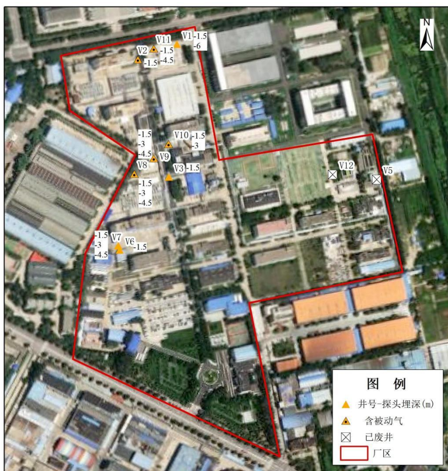
图 8.1-2 土壤气采样井空间分布及采样深度示意图
